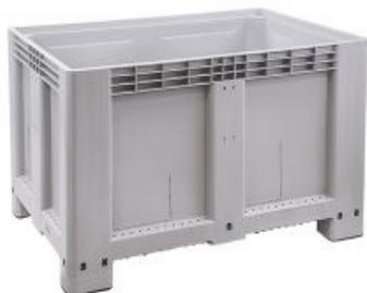
Contentor-paleta 1200x800x800mm, em HDPE com 4 pés. Paredes e fundo fechados. Dimensões internas: 1115x715x600mm. A capacidade de 525 litros.
