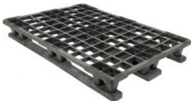
paleta de plástico leve para exportação com 3 patins 1200x800x138mm, com rebordo. Esta paleta tem uma capacidade estática de carga de 2,000 kg, uma capacidade de carga dinâmica de 1.200 kg e uma capacidade de carga trasfega de 300 kg.
