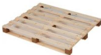
Palete de madeira para cargas leves devido à sua carga máxima de 400 kg. As dimensões da paleta são 1200x1000x120mm, e tem +/- 7 ripas superiores, 3 travessas, 9 tacos e 3 patins. Esta paleta usada pode ser usada várias vezes com os devidos cuidados.
