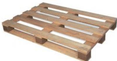
Este palete de madeira tem as dimensões 1200x800x155mm, e consiste em cinco ripas superiores, três travessas, nove tacos e três painéis inferiores. A capacidade máxima de carga é de 1000 kg adequada para cargas pesadas. O peso próprio é de 18 kg
